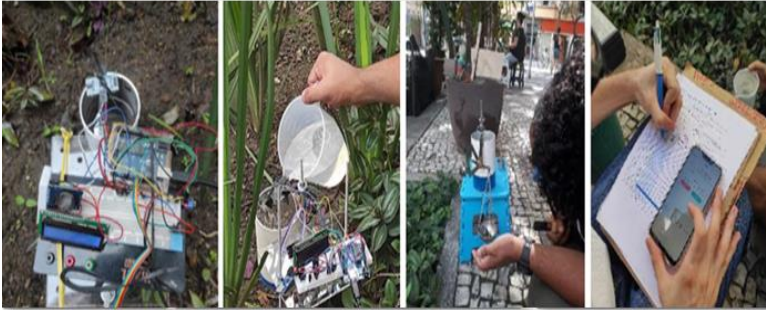
Protótipo de monitoramento ambiental acoplado a infiltrômetro de anel
